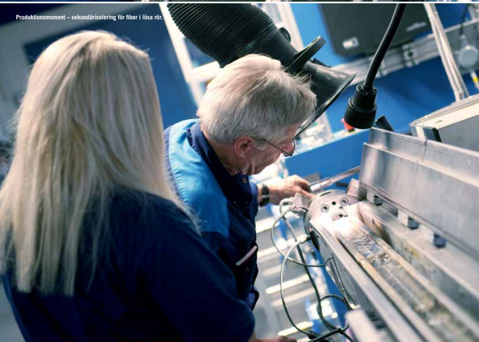
Produktionsmoment – fiber för ribbonisering.
